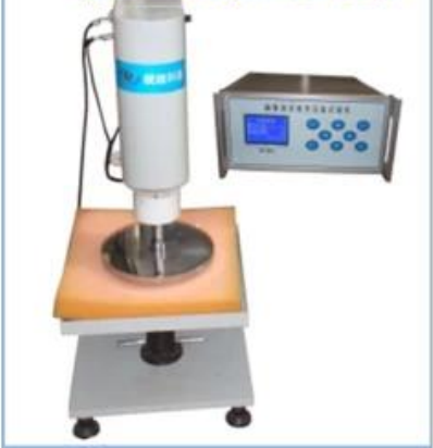
• 海绵泡沫疲劳压陷试验机
