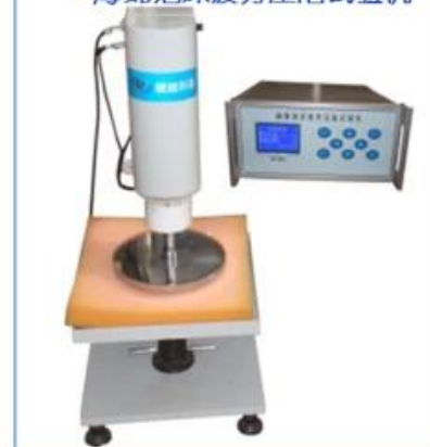
• 海绵泡沫疲劳压陷试验机
