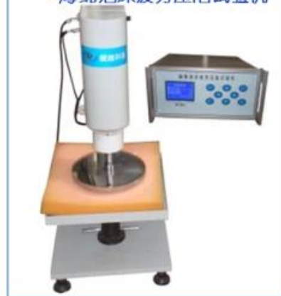
• 海绵泡沫疲劳压陷试验机
