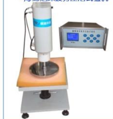
• 海绵泡沫疲劳压陷试验机
