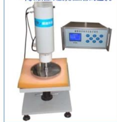
• 海绵泡沫疲劳压陷试验机
