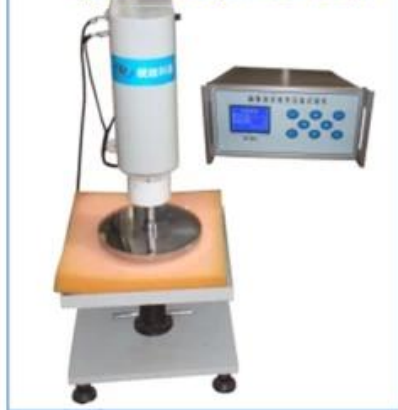
• 海绵泡沫疲劳压陷试验机
