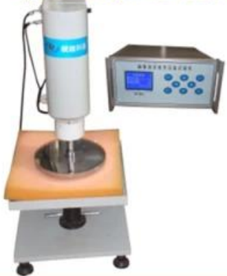
• 海绵泡沫疲劳压陷试验机
