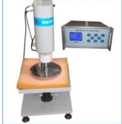
• 海绵泡沫疲劳压陷试验机
