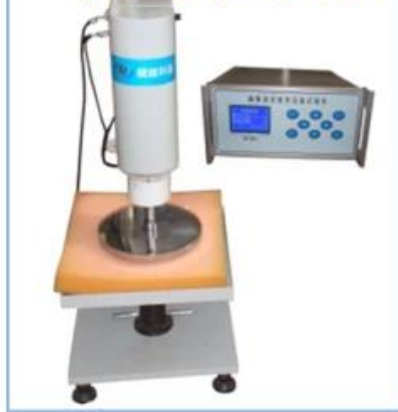
• 海绵泡沫疲劳压陷试验机
