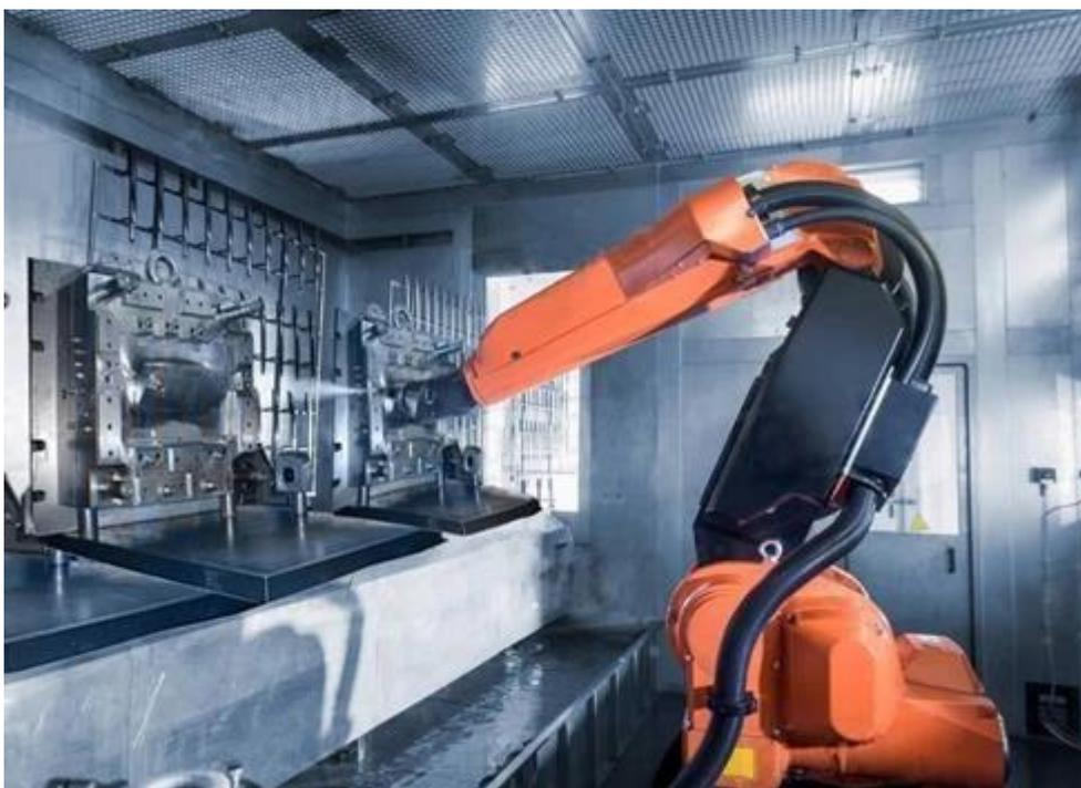
**Lackierroboter mit Formtrennmittel**
