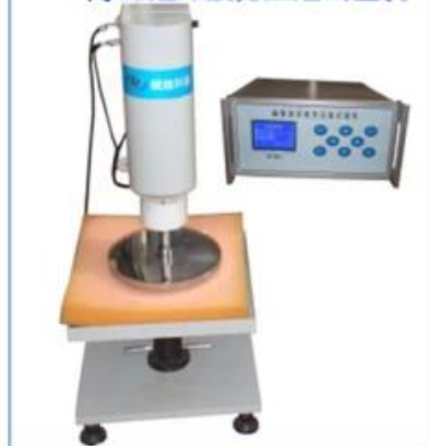
• 海绵泡沫疲劳压陷试验机
