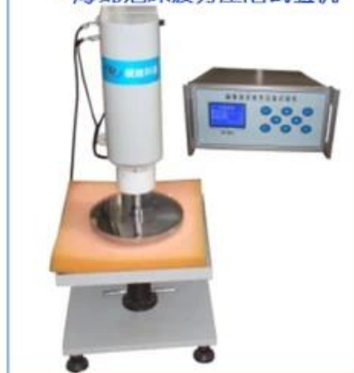
• 海绵泡沫疲劳压陷试验机
