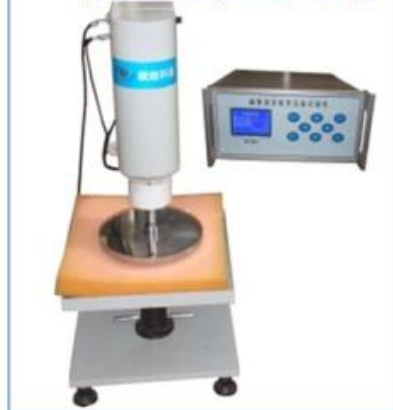
• 海绵泡沫疲劳压陷试验机
