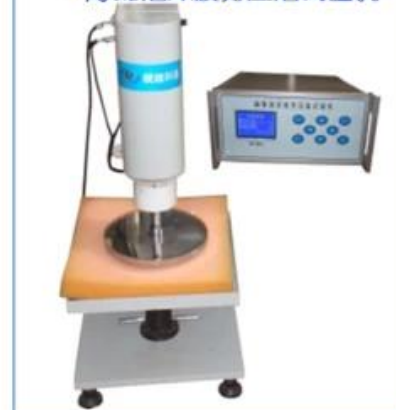
• 海绵泡沫疲劳压陷试验机
