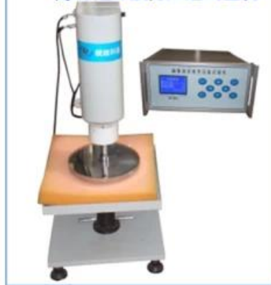
• 海绵泡沫疲劳压陷试验机
