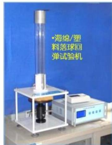
• 海绵/塑料落球回弹试验机
