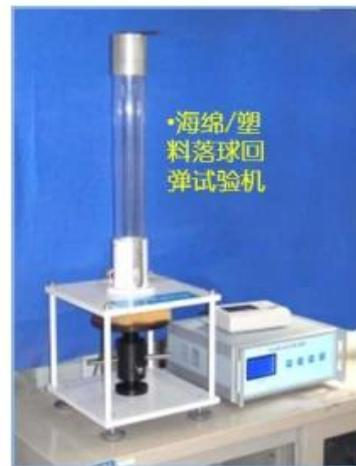
• 海绵/塑料落球回弹试验机
