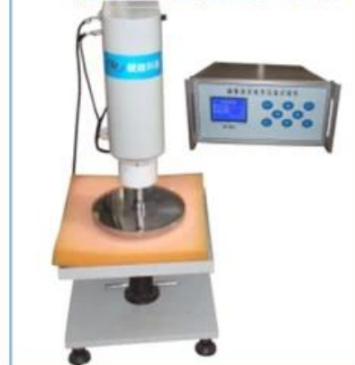
• 海绵泡沫疲劳压陷试验机
