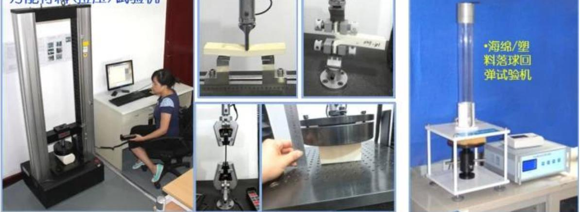
•海绵/塑料落球回弹试验机
