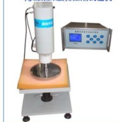
• 海绵泡沫疲劳压陷试验机
