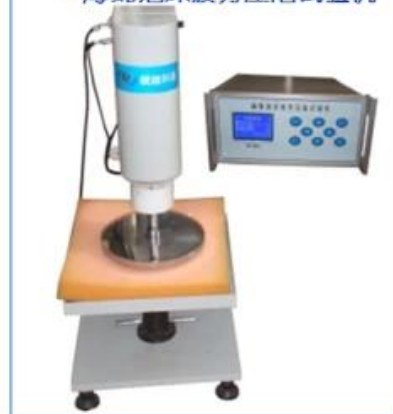
• 海绵泡沫疲劳压陷试验机
