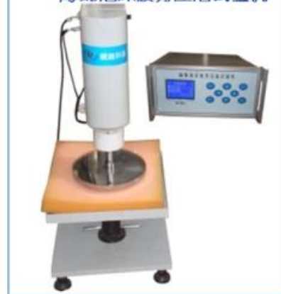
• 海绵泡沫疲劳压陷试验机
