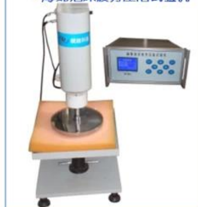
• 海绵泡沫疲劳压陷试验机
