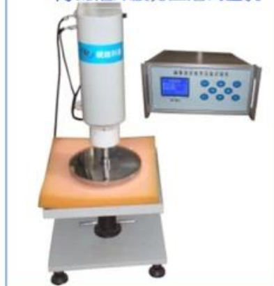
• 海绵泡沫疲劳压陷试验机
