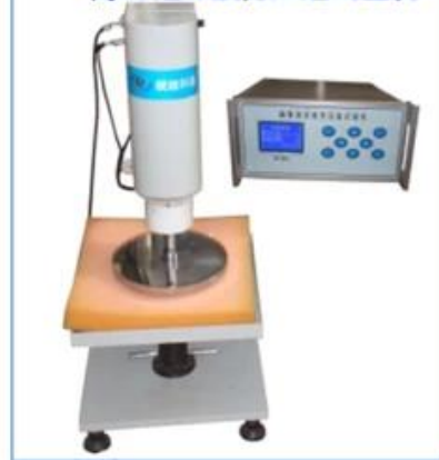
• 海绵泡沫疲劳压陷试验机
