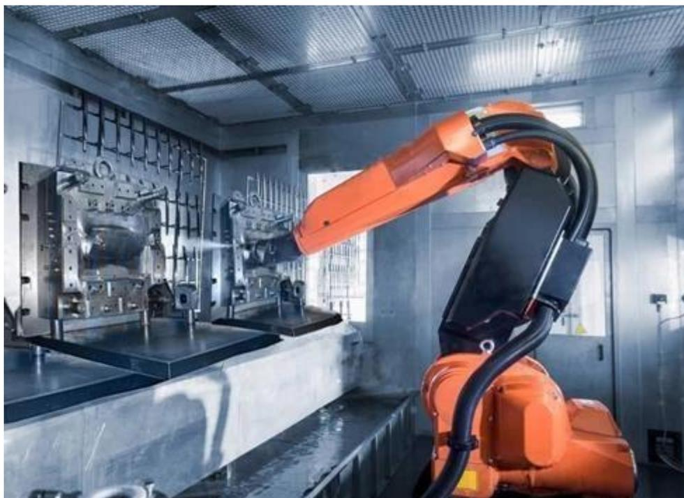
**Agente di rilascio della muffa Robot di pittura**
