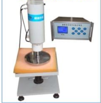
• 海绵泡沫疲劳压陷试验机
