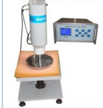
• 海绵泡沫疲劳压陷试验机
