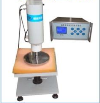
• 海绵泡沫疲劳压陷试验机
