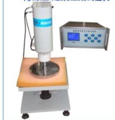
• 海绵泡沫疲劳压陷试验机
