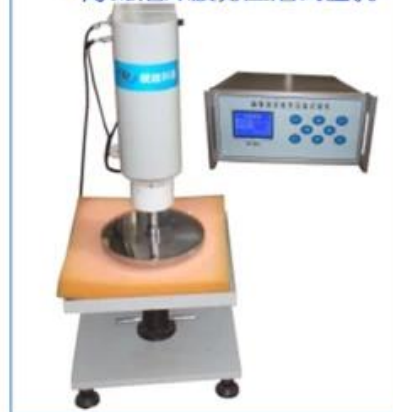
• 海绵泡沫疲劳压陷试验机
