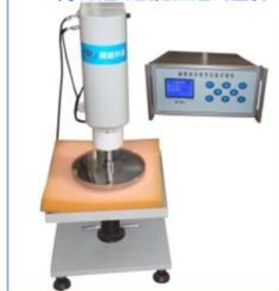
• 海绵泡沫疲劳压陷试验机
