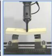
• 万能材料(拉压)试验机
