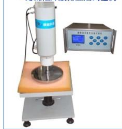
• 海绵泡沫疲劳压陷试验机
